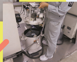
▲圧力タンクを開けて補充する様子
